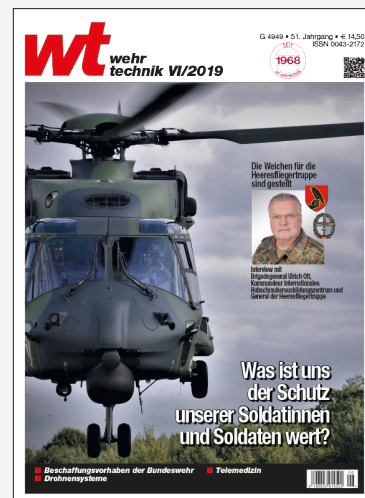
Titelbild: Der Transporthubschrauber NH90 ist nicht hinreichend gegen Bedrohungen wie tragbare Luftabwehrsysteme oder Luft/Luft-Lenkflugkörper geschützt. Ausgerüstet mit speziellen gerichteten Infrarot-Gegenmaßnahmen ist es möglich, das Luftfahrzeug effektiv gegen aktuelle und künftige Bedrohungen zu schützen. (Foto: Mönch/VoSch)
